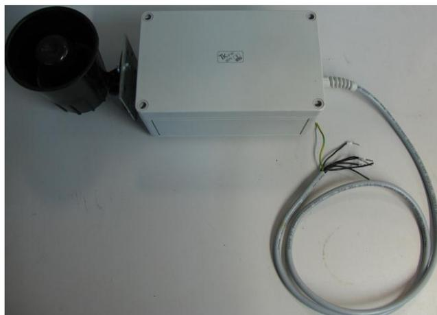
Устройство УЗС обеспечивает слабовидящих граждан при пересечении проезжей части в зоне регулируемого пешеходного перехода, информацией о наличии зеленого сигнала светофора с помощью звукового сигнала. В утреннее и вечернее время суток звуковой сигнал излучается на пониженной громкости, в ночное время суток – отключается полностью.
